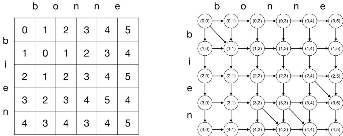
FIGURE 4 – Exemple de matrice de distance d’édition et de graphe associé (les poids des arcs ont été volontairement omis).
